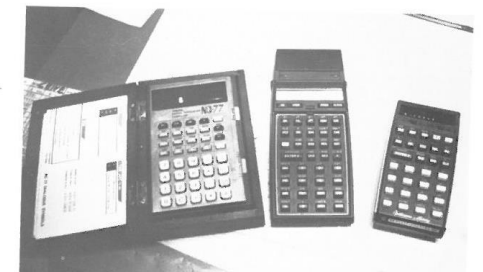
Fig. 9 De 'hersens' van de Flying Wilma (1980) op een rijtje, van links naar rechts: de NC-77-navigatiecomputer, de HP41C-programmeerbare zakcomputer met dialoog (en printer) en een kleine HP-wetenschappelijke zak-computer. Op de Flyer (1978) werd nog uitsluitend de HP65 gebruikt.
